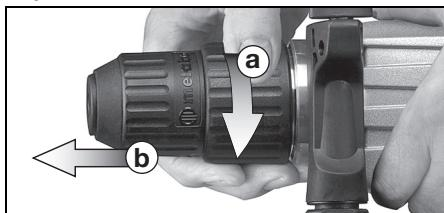
tourner le verrouillage du mandrin (5) dans le sens de la flèche jusqu'en butée (a) et retirer le mandrin (b).
