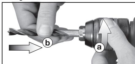
tourner la douille (4) dans le sens marqué "AUF, OPEN" (a). Introduire l'outil aussi profondément que possible (b) et tourner la douille en sens inverse jusqu'à ce que la résistance mécanique que l'on sent soit surmontée. **Attention ! L'outil n'est alors pas encore serré !**
