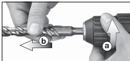
tourner la douille de l'outil (3) dans le sens de la flèche (a) et retirer l'outil (b).
