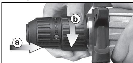
Placer le mandrin sur la broche (6) (a). Tourner le verrouillage du mandrin (5) dans le sens de la flèche (b) jusqu'à ce que le mandrin puisse entièrement glisser sur la broche, puis lâcher le verrouillage du mandrin. Contrôler si le mandrin est bien en place.
