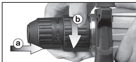
Coloque el portabrocas en el husillo (6) (a). Gire el cierre del portabrocas (5) en el sentido de la flecha hasta que el portabrocas se deslice completamente en el husillo y suelte el cierre del portabrocas. Compruebe que el portabrocas está bien sujetado.
